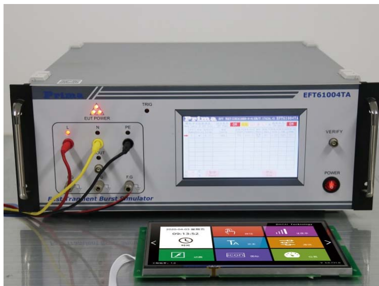
图 3-4 群脉冲测试图
