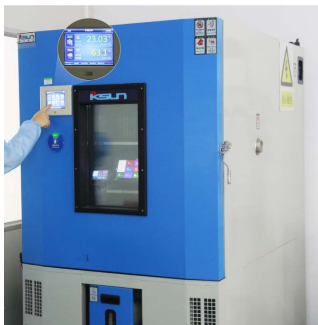
图 3-3 高低温老化测试图
