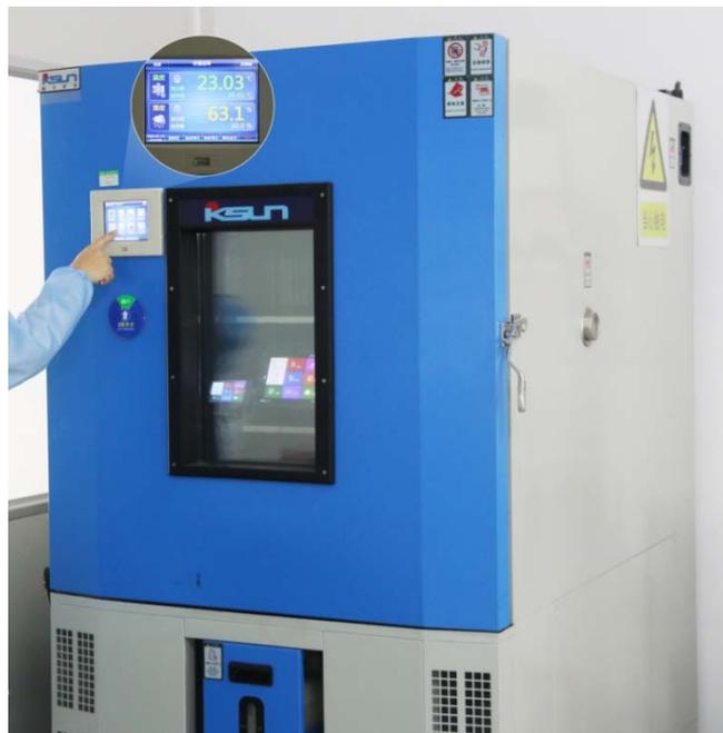
图 3-3 高低温老化测试图
