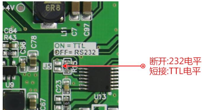
图 6-1 RS232 和 TTL 转换示意图
