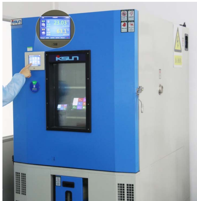
图 3-3 高低温老化测试图
