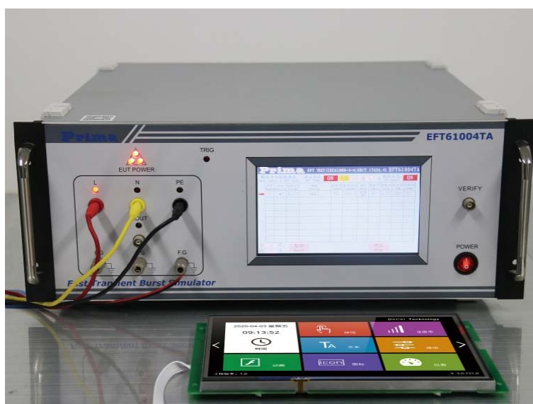
图 3-4 群脉冲测试图
