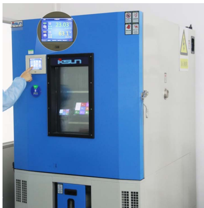
图 3-3 高低温老化测试图
