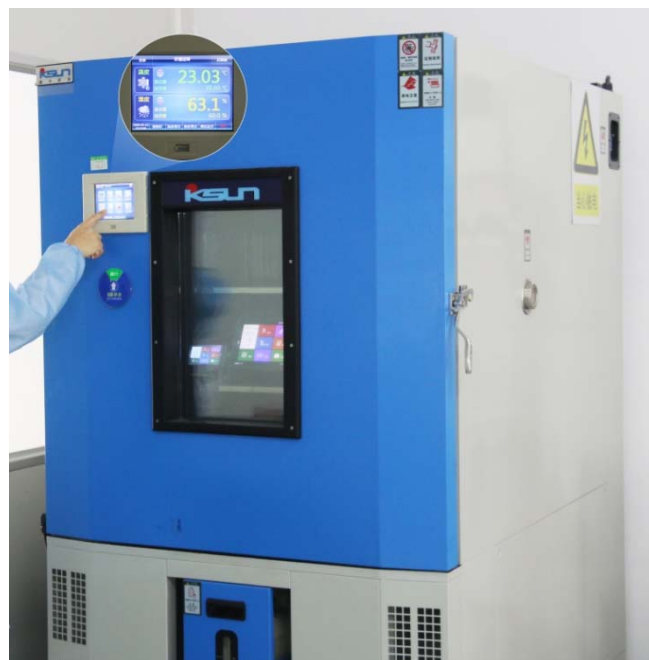
图 3-3 高低温老化测试图
