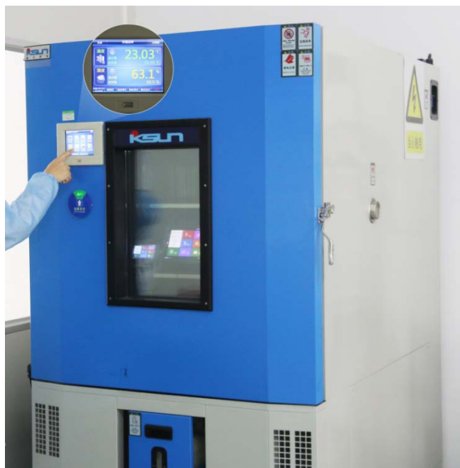
图 3-3 高低温老化测试图
