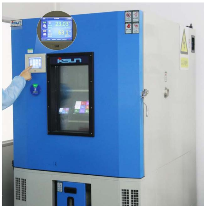
图 3-3 高低温老化测试图
