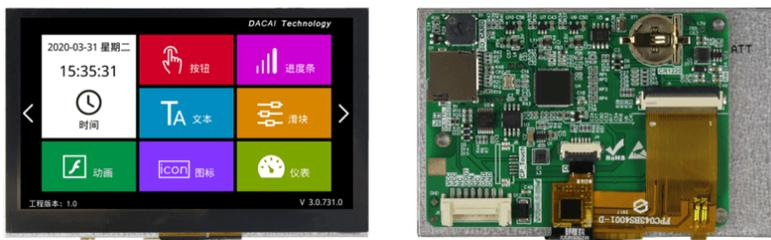
图 1-2 4.3 寸电容触摸参考图
