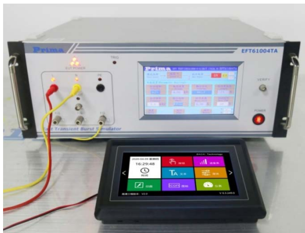
图 6-4 群脉冲测试图
