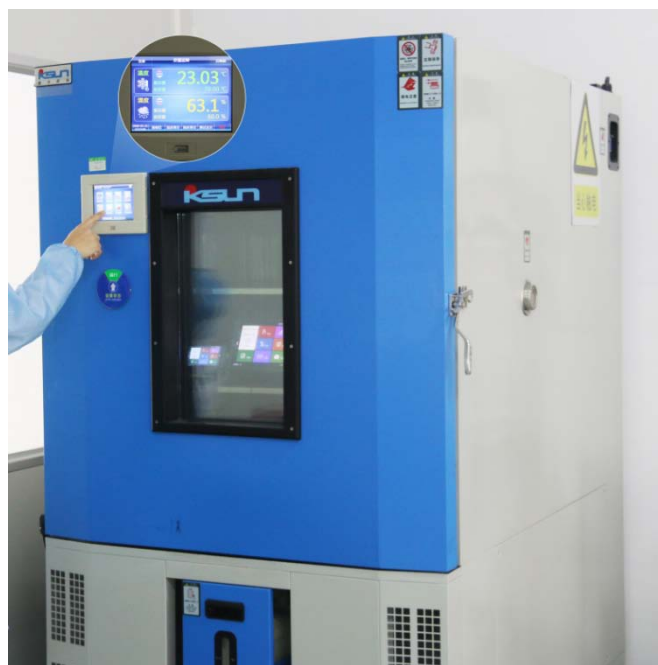
图 6-3 高低温老化测试图
