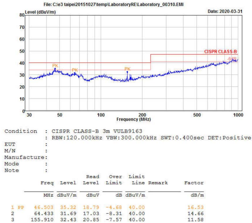
图 6-7 辐射测试垂直方向
