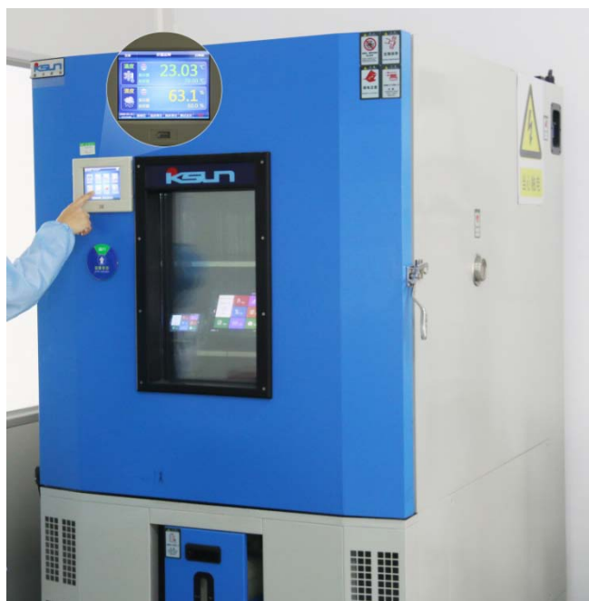
图 6-3 高低温老化测试图
