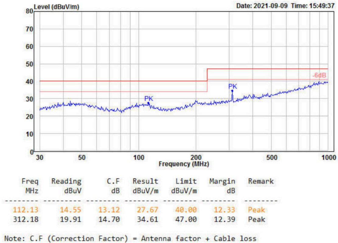
图 3-6 辐射测试水平方向
