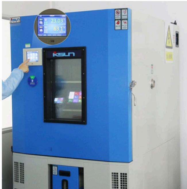
图 3-3 高低温老化测试图
