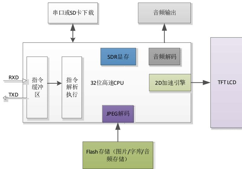
图 10-1 M 系列串口屏内部结构图
