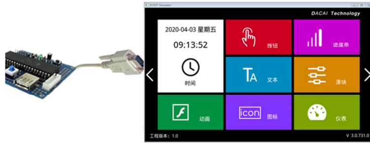
图 12-2 用户单片机串口与“虚拟串口屏”联机调试
