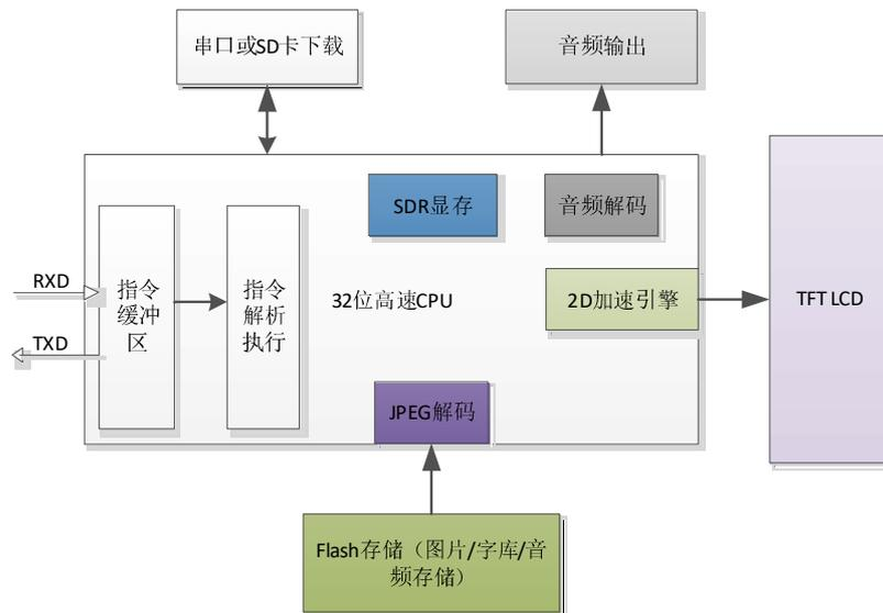
图 11-1 M 系列串口屏内部结构图
