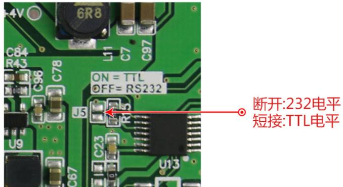
图 7-1 RS232 和 TTL 转换示意图
