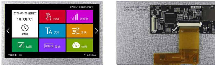
图 1-2 4.3 寸无触摸参考图
