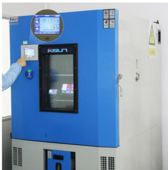
图 6-3 高低温老化测试图
