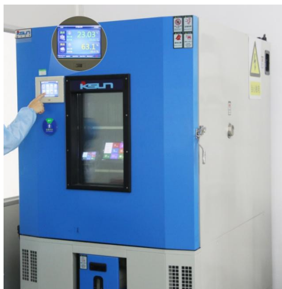
图 6-3 高低温老化测试图
