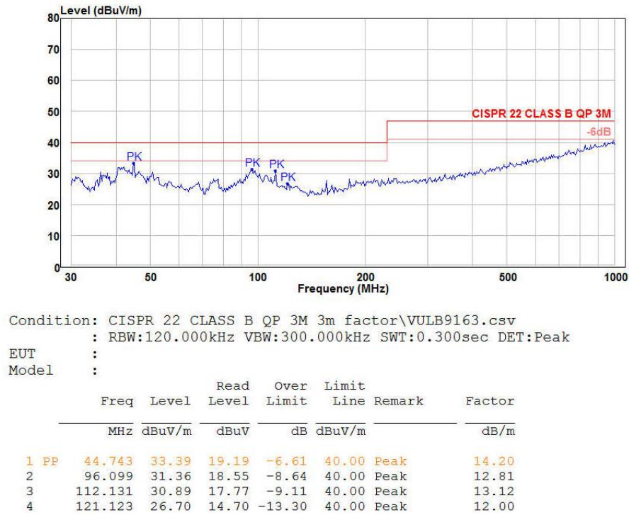
图 3-7 辐射测试垂直方向
