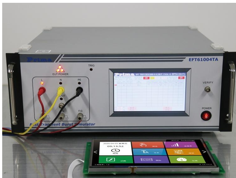
图 3-4 群脉冲测试图
