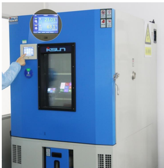
图 3-3 高低温老化测试图
