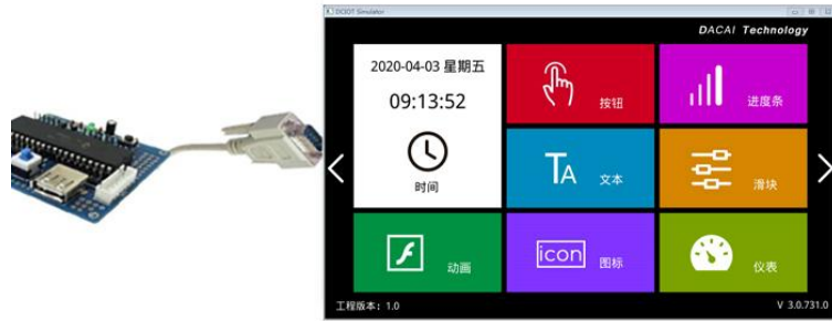
图 11-2 用户单片机串口与“虚拟串口屏”联机调试
