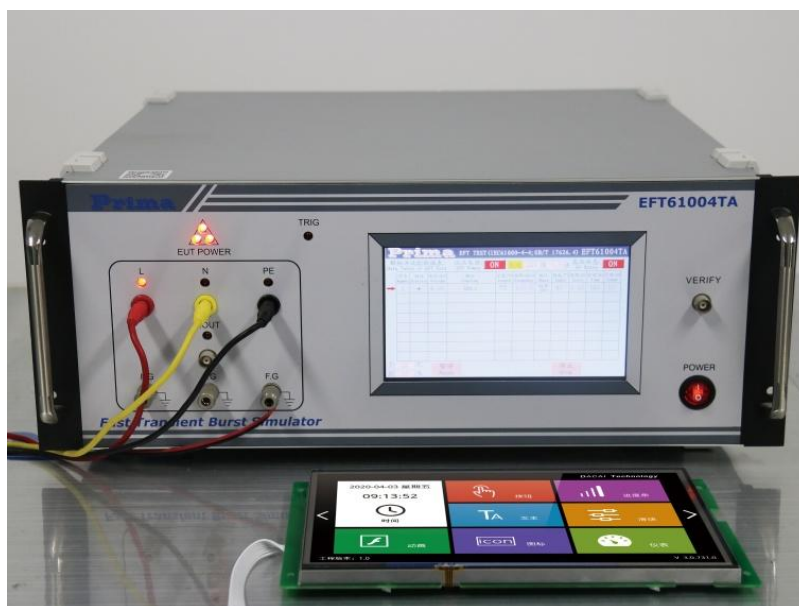
图 3-4 群脉冲测试图
