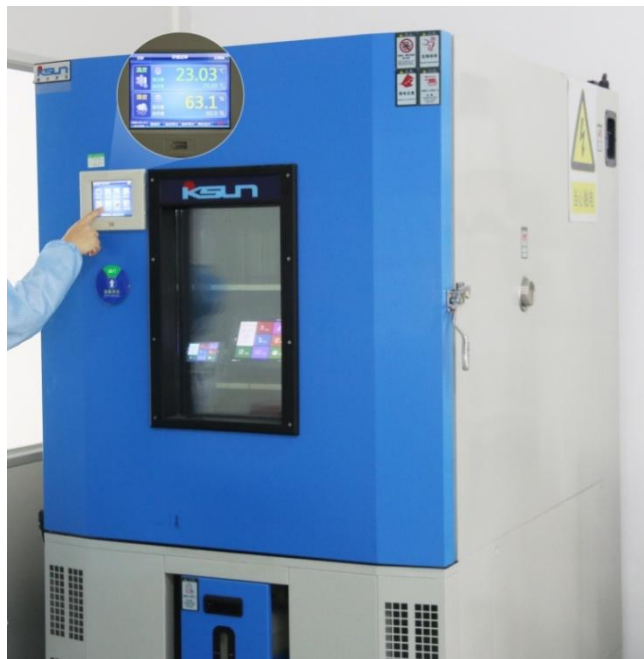
图 3-3 高低温老化测试图
