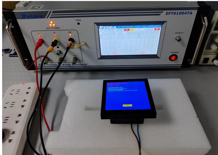
图 6-4 群脉冲测试图
