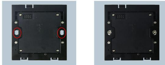
**第二步：把底壳固定在有暗盒的墙上或者固定在客户机柜上，将螺丝插入如图红色标识位置的安装孔中并拧紧螺丝**
