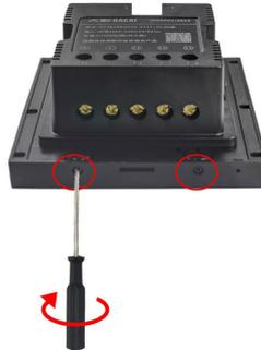
**第一步：在如图红色标识位置拧开螺丝（在后续步骤会用到），打开底壳**
