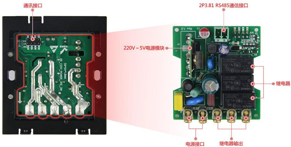
图 1-5 电源板硬件配置图
