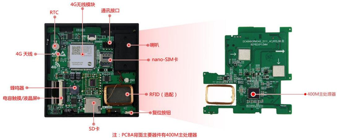
图 1-4 带 4G、RFID 硬件配置图
