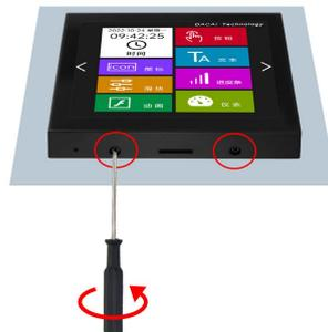
**第四步：在如图红色标识位置，拧上第一步拆下的螺丝，固定串口屏**
