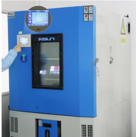
图 6-3 高低温老化测试图
