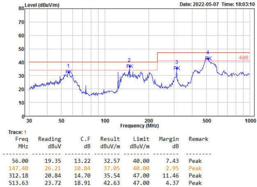
图 6-7 辐射测试垂直方向
