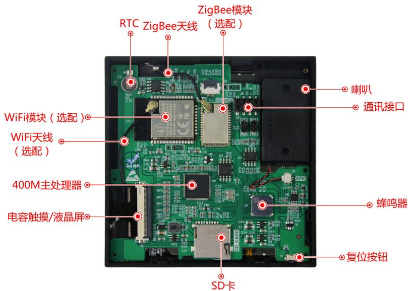
图 1-3 带 WiFi、ZigBee 硬件配置图
