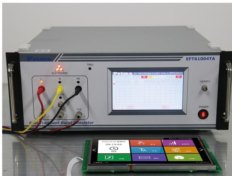
图 5-4 群脉冲测试图
