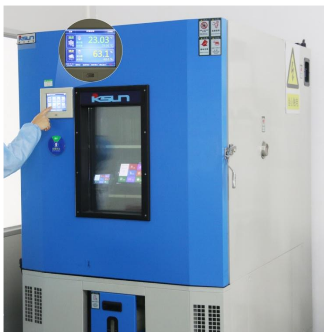
图 5-3 高低温老化测试图
